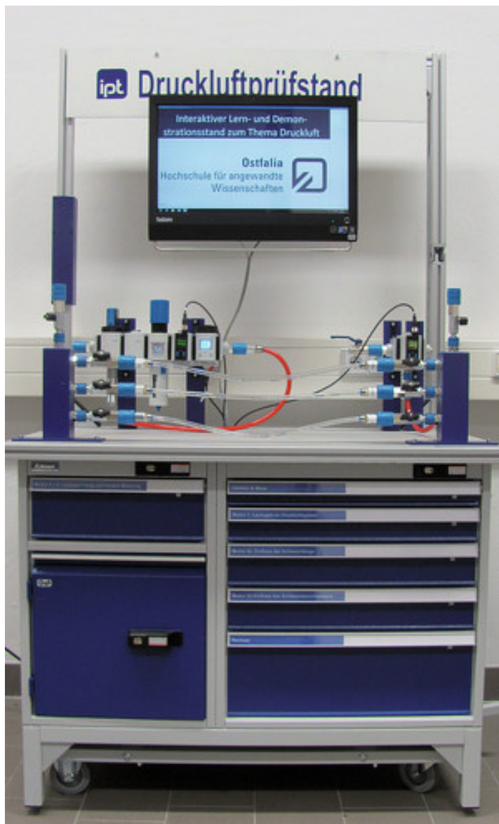
Bild 1: Der interaktive Lernstand für Druckluffteffizienz basiert auf einem rollbaren Werkzeugschrank, der mit Monitor, Arbeitsumfeld, Modulflächen,
