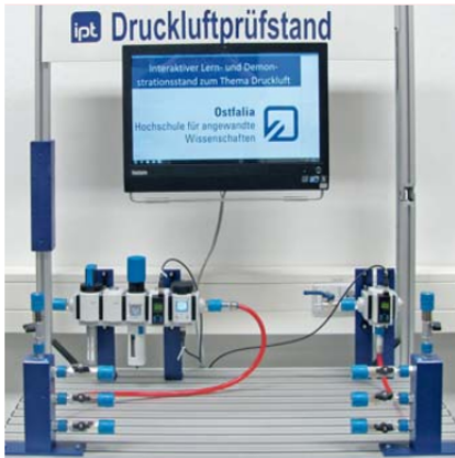
Der interaktive Druckluftstand dient zur Schulung von Mitarbeitern und zur mobilen Verbrauchsmessung in der Produktion.
